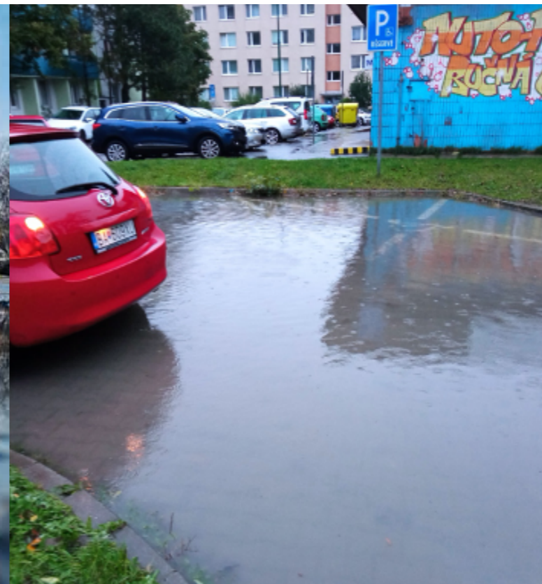
Zrážkovú vodu zo spevnených plôch a chodníkov je potrebné vyspádovaním viesť do plôch zelene Foto: Zuzana Hudeková
